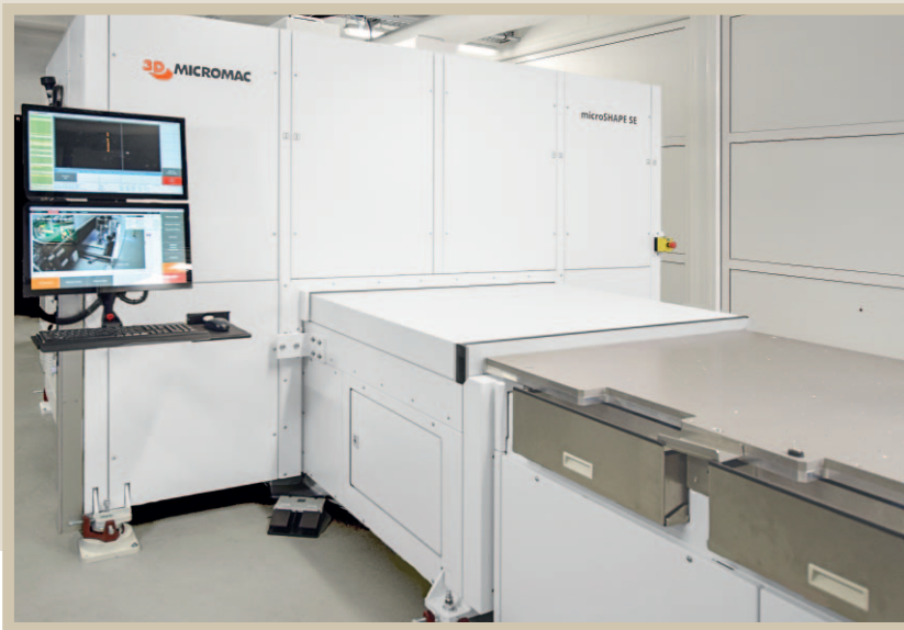
Bild 5. Das Laserschneidsystem »microShape« von 3D-Micromac eignet sich dazu, ultradünnes Glas mit einer UKP-Laserquelle zu schneiden
