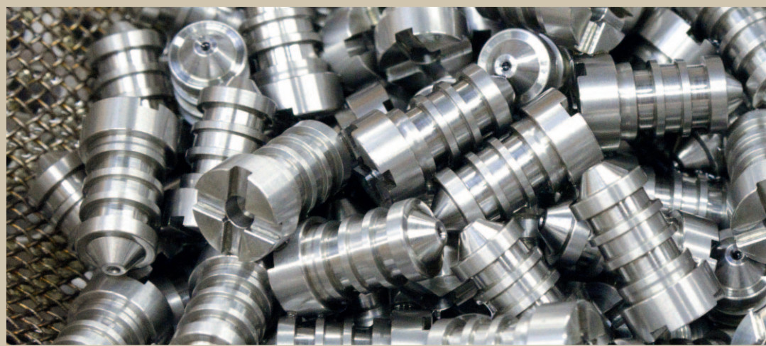
Bild 2. In Serien von einigen Tausend Werkstücken fertigt das Unternehmen Trico auf Lang- und Kurzdrehautomaten unter anderem kleine Düsenkörper für die Pneumatik
