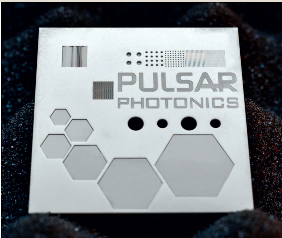
Bild 1. Beispielhafte Strukturierung einer \text{Al}_2\text{O}_3 -Keramik: UKP-Laser, (IR) mit 900 fs und 20 W, mittlere Leistung 10 bis 15 W
