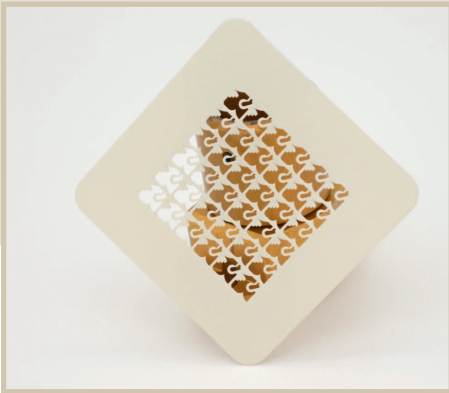
Bild 4. Die (geometrische) Freiheit nehm ich mir: Demonstrator für einen Laserfeinschneidprozess in einer Aluminiumoxidkeramik. IR Laser, 20 W, Genauigkeiten < 5 µm, Ablationsrate 3 bis 5 mm³/min
