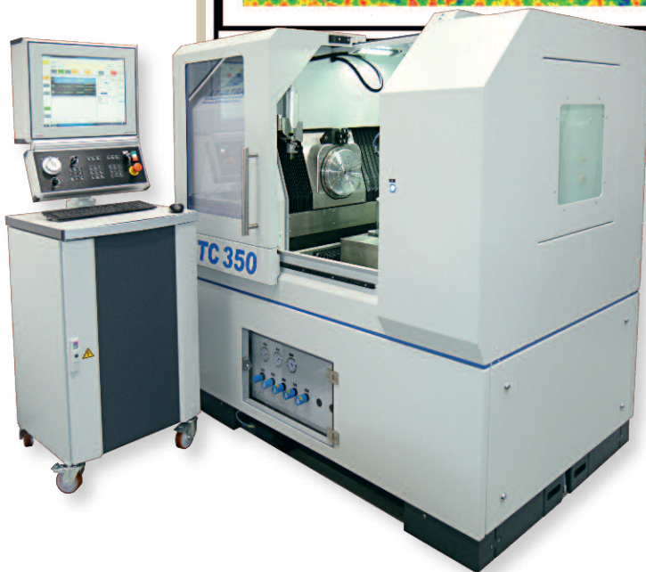
Bild 4. Bei der Ultrapräzisions-drehmaschine »MTC 350« werden die Positionen der bis zu fünf Achsen durch hochauflösende Messsysteme geregelt
