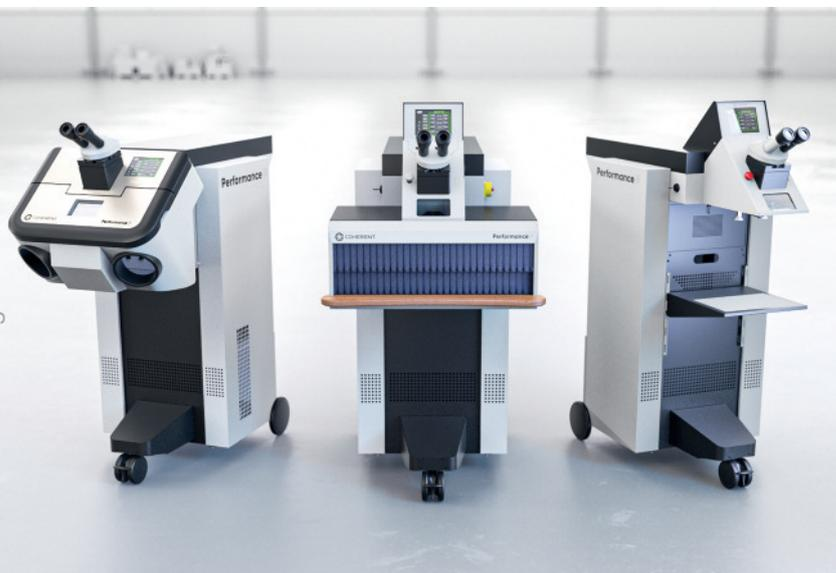
**Optional mit Faserlaser: Die Handschweißlaser der »Performance«-Serie verfügen damit über eine höhere Tiefenschärfe sowie deutlich bessere Puls-zu-Puls-Konsistenz und Langzeitstabilität**
