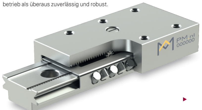
Bild 3. Innenansicht der Käfigzangssteuerung: Die Zahnstange ist im durchgehärteten Material integriert, benötigt keine Klebstoffe und ist daher sehr robust und zuverlässig
