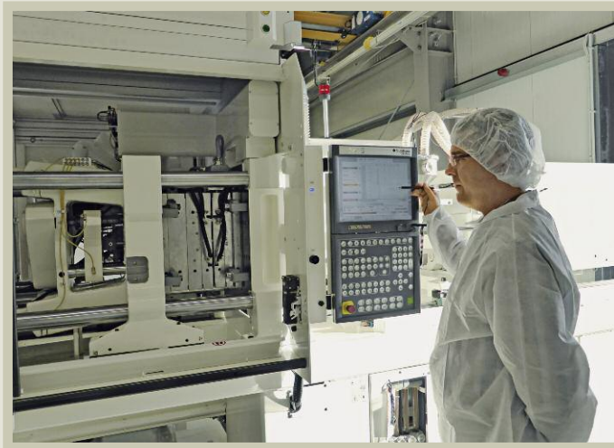
Bild 3. Tobias Lacroix, Leiter der Mikrospritzgießabteilung von thinXXS, ist mit der vollelektrischen Spritzgießmaschine »IntElect« von Sumitomo (SHI) Demag vollständig zufrieden. Sie erzielt extrem hohe Abbildgenauigkeiten und Reproduzierbarkeiten mit Bauteiltoleranzen im \mu\text{m} -Bereich
