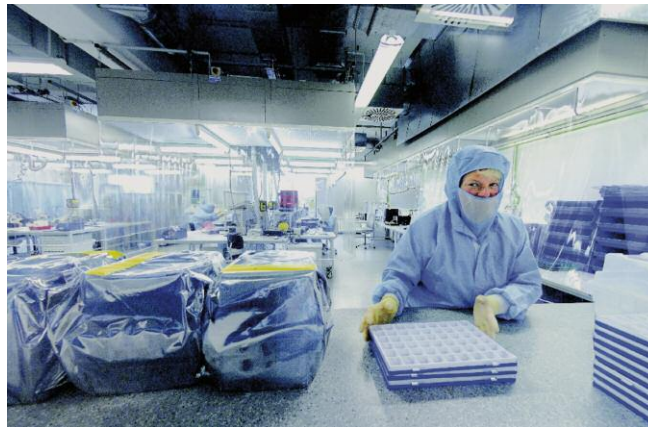
Bild 6. Hier herrscht das Vermummungsgebot: Die Mitarbeiter montieren und verpacken unter Reinraumbedingungen der Klasse 7 – da darf kein Haar oder Stäubchen in die Endprodukte gelangen
