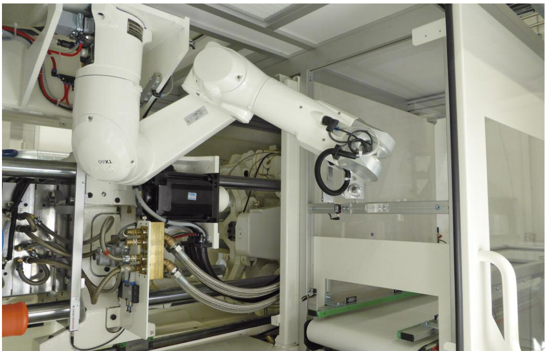
Bild 4. Der 6-Achs-Knickarmroboter entnimmt die fertigen Test-Komponenten aus dem Vierfach-Werkzeug und befüllt mit ihnen anschließend einen kleinen Ladungsträger. Ist dieser vollständig befüllt, verschwindet er auf dem Förderband in Richtung Montagehalle
