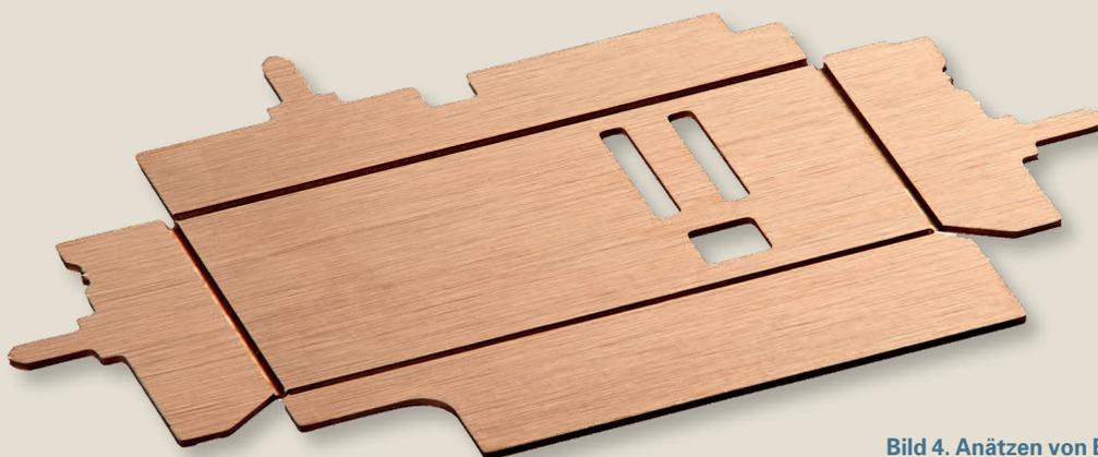
Bild 4. Anätzen von Biegekanten
