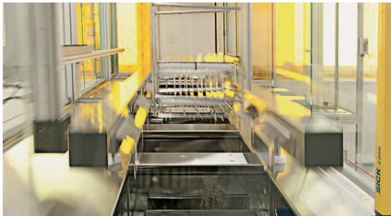
**Bild 3. Die Anlage verfügt über insgesamt elf Stationen, davon sieben Tauchbecken für Reinigungs- und Spülschritte, die flexibel angefahren werden können**
