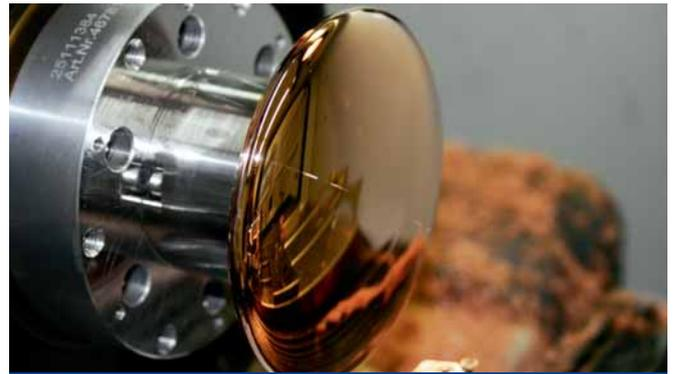
Elektrode für Teilchenbeschleuniger
