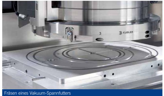
Fräsen eines Vakuum-Spannfutters
