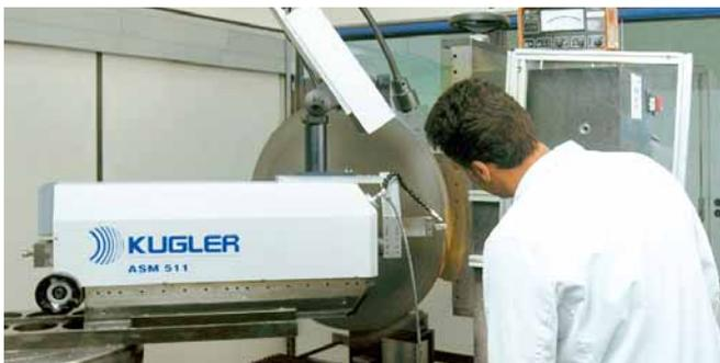
Bearbeitungsarm mit Laserinterferometer
