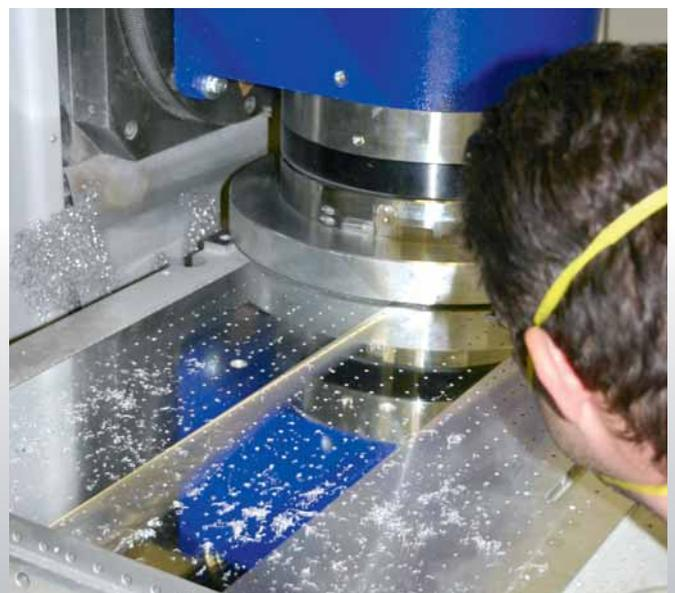
FLYCUTTER-Bearbeitung eines Aluminiumbauteils
