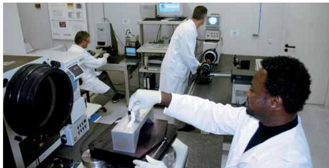
Messraum mit 12"-Fizeau-Interferometer
