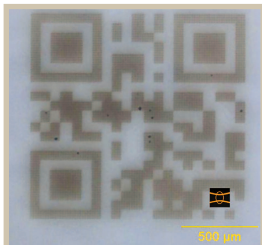
Bild 8. Links: akustooptische Glasinnenmarkierung in 73 ms, rechts: Oberflächenmarkierung von Edelstahl (1.4301), Pixelgröße 75 \mu\text{m}
